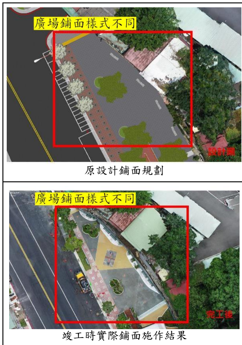
圖表 2-31 傳統設計方式，竣工階段變更設計，設計圖變更與審圖階段被直接忽略。廣場鋪面實際施作與設計內容不符
