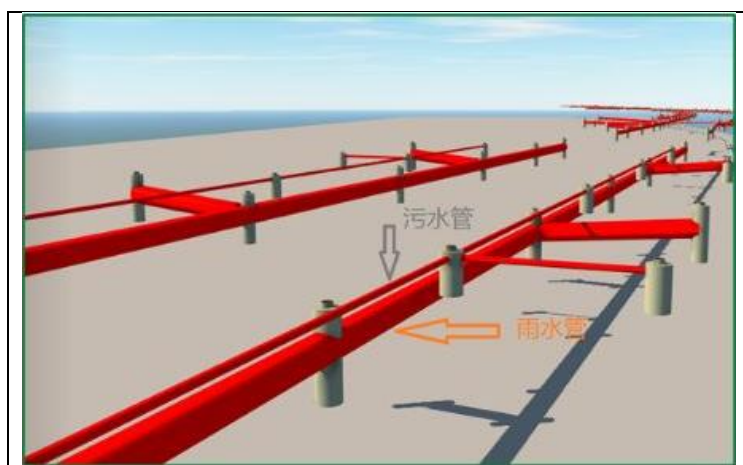
圖表 2-21 雨水、污水管線衝突示意圖
