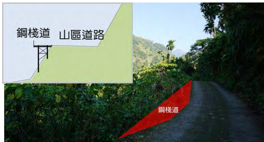
圖 7.7-1 棧道施工示意圖(一)
