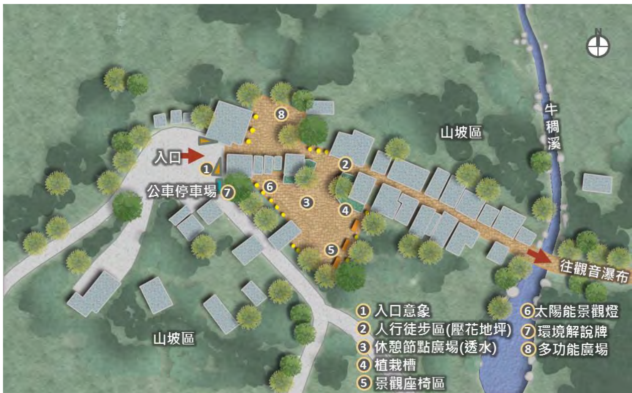
圖 7.4-2 入口段改善設計平面配置圖
