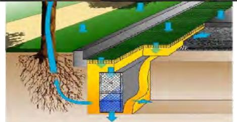
通氣且排水良好，利於植栽生長，儲留雨水，將水源作灌溉等再次運用，不僅提高基地節水率，且有效收集雨水並過濾，更增加回收水資源，減少資源浪費。
