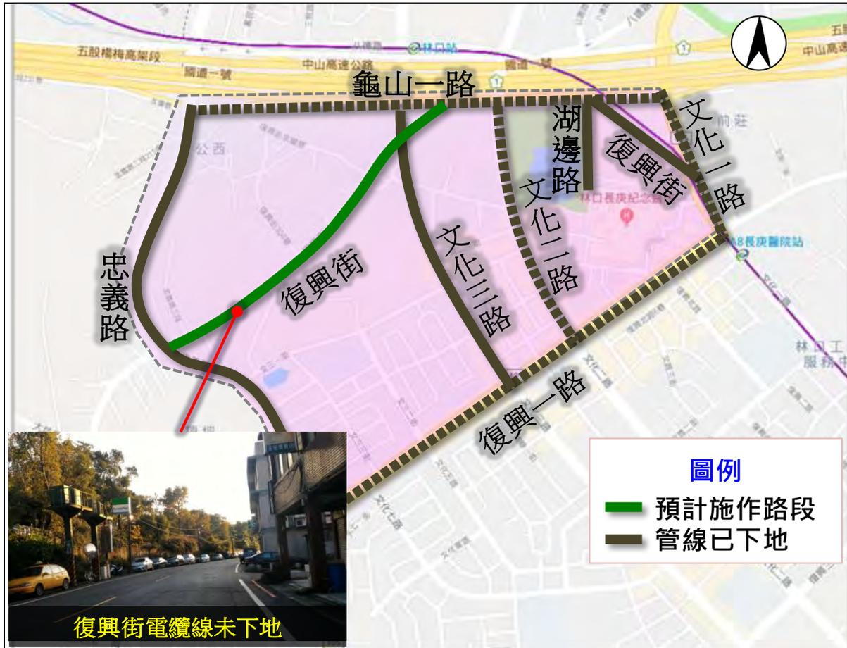
圖 25 本計畫範圍預計施作共同管(線)溝路段示意圖
