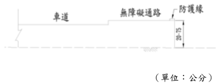
圖 14.1.1 無障礙通路設置防護緣示意圖
