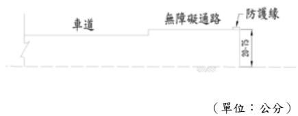
圖 14.1.1 無障礙通路設置防護緣示意圖
