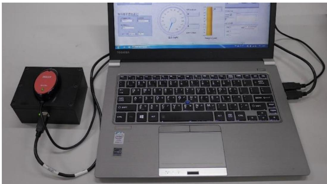
圖 4 簡易型平整儀與電腦連接
