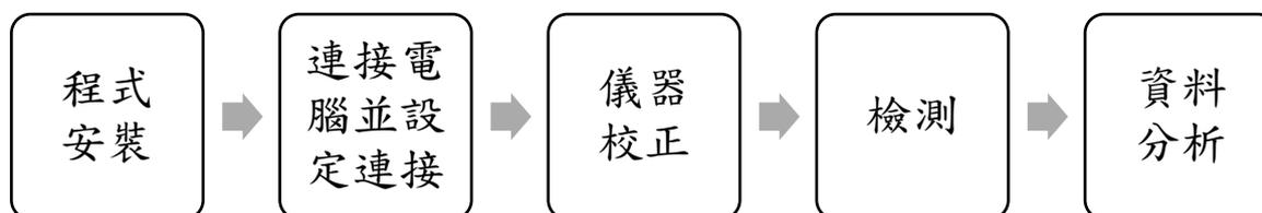
圖 2 簡易型平整儀使用步驟
