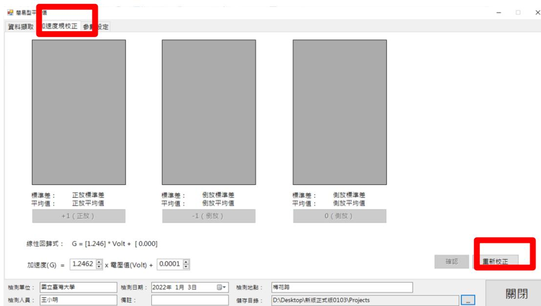
圖 19 加速度規校正—按下「重新校正」
