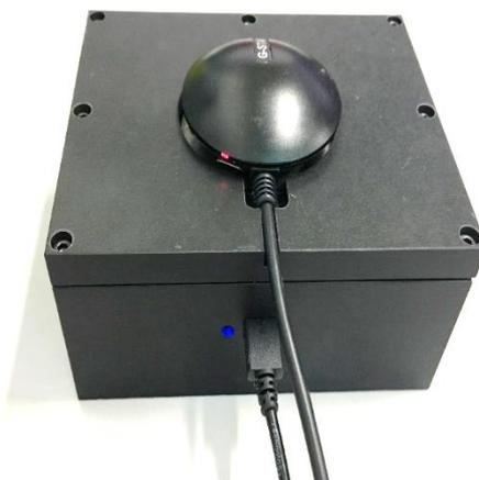
圖 5 簡易型平整儀連接正確時亮燈情形
