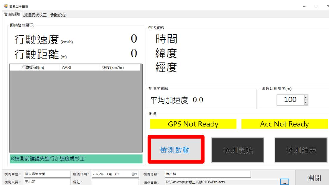
圖 24 按下「檢測啟動」確認儀器連接正常
