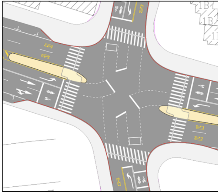
圖 5.3-3 機慢車左（右）轉待轉區線示意圖
