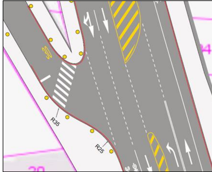
圖 2.6-4 無號誌鄉區斜交三叉路口設置行穿線圖例
