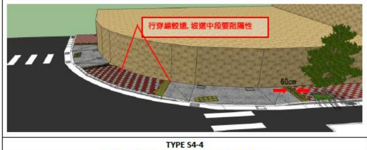
圖 7-11 圓通路人行道端部及中央無障礙坡道配置
